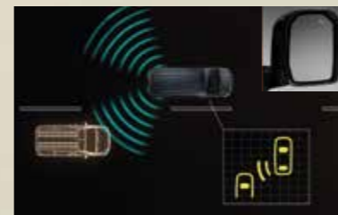
ระบบช่วยเตือนมุมอับสายตาที่ระจกมองข้าง (Blind Spot Monitor)
