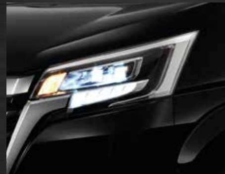
ไฟหน้าแบบ LED พร้อมไฟส่องสว่างเวลากลางวัน
